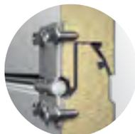
**4 couches de métal** au point de fixation des vis autotaraudeuses assurent la solidité élevée : les panneaux ne sont pas endommagés même lorsque les portes sont brusquement abaissées.
